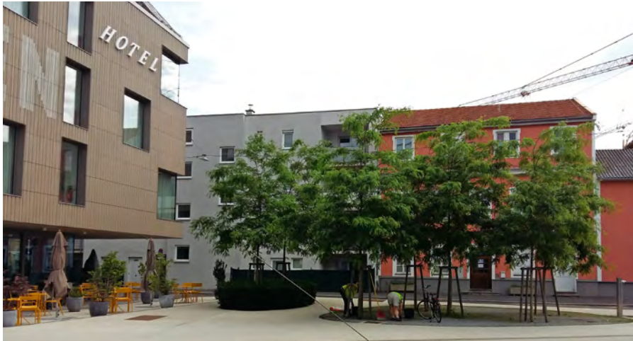
Gleditsia triacanthos vor dem Grazer Lendhotel: Die wassergebundene Decke wurde mit Struktursubstrat (32/64 Kantkorn und Pflanzenkohle/Sandgemisch trocken abgemischt) in einer Stärke von 60 cm unterbaut. Der gesamte Platz entwässert in die Baumscheiben. Die Bäume sind auf dem Foto im dritten Standjahr.
