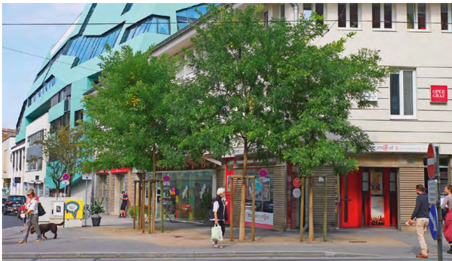
Styphnolobium japonicum neben der Grazer Oper: Hier wurde Struktursubstrat unter der gesamten Pflasterfläche 60 cm stark eingebaut. Die Bäume sind auf dem Foto im dritten Standjahr. Sie haben im Vergleich zu den gegenüberliegend gepflanzten Bäumen in Betonkörben ohne zusätzliche Regenwasserversickerung einen rund 20 % größeren Stammdurchmesser.
