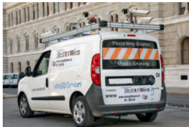
Vermessungsfahrzeug der „Mobile Mapping“-Kampagne
