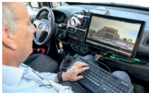
Mitarbeiter bei der Erfassung von Bilddaten für die Vermessung und Digitalisierung des öffentlichen Raums
