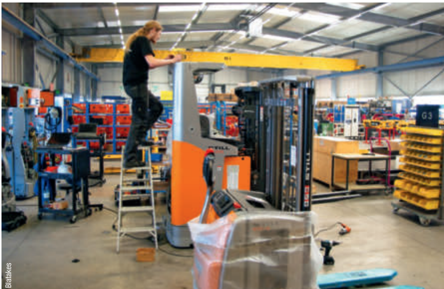
Ein Mitarbeiter von DS Automation verpasst dem selbstfahrenden Staplerfahrzeug den letzten Schliff. Eingesetzt wird es später in riesigen Versand-Lagerhallen, die in Zeiten des Onlinehandels boomen.
